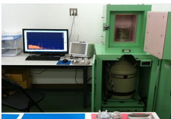
ゲルマニウム半導体検出器と γ線スペクトル解析
